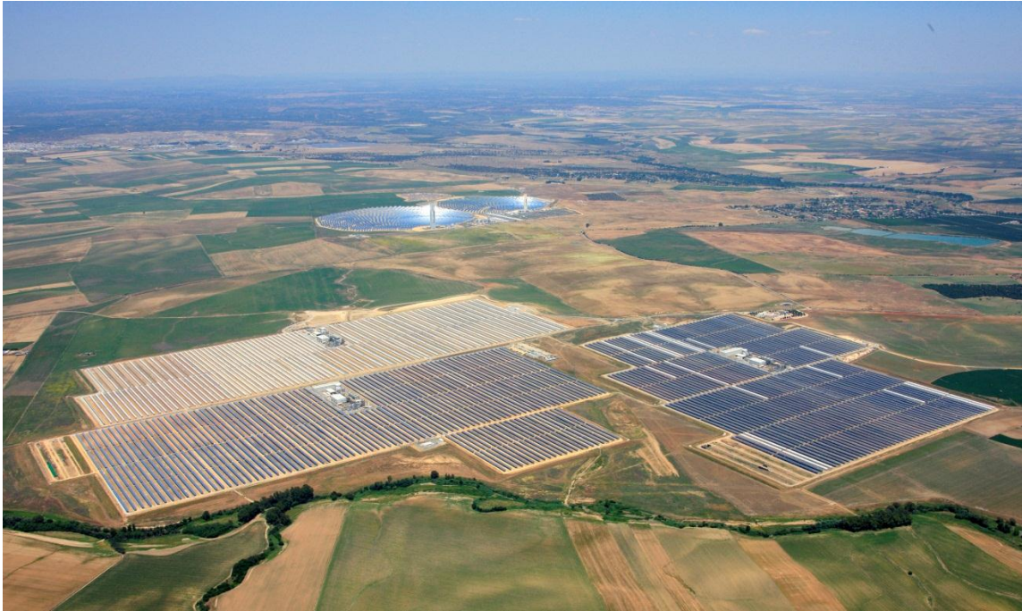
Abb. 4: Parabolrinnen-Solkraftwerke Solnova 1, 3 und 4 (3 x 50 MW el ) in San Lucar in der Nähe von Sevilla. Im oberen Teil des Bildes sind die beiden Solarturm-Kraftwerke PS 10 und PS 20 mit einer Leistung von 10 bzw. 20 MW el zu erkennen. (Quelle: Wikipedia)
